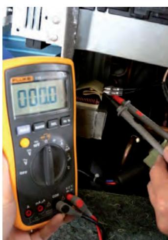
Obr. 56: Měření transformátoru
