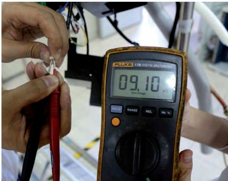
Obr. 58: Kontrola senzorů
