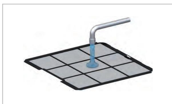
Obr. 62: Čištění vlažnou vodou
