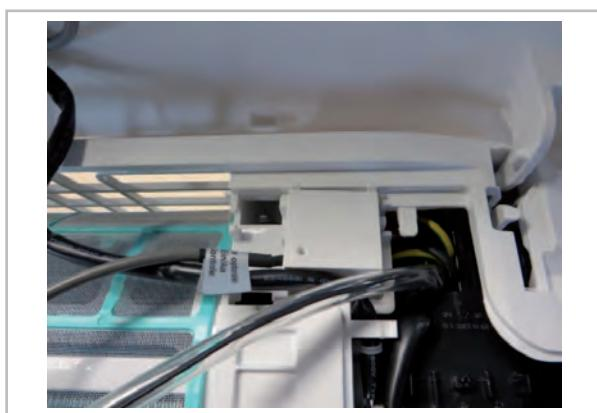
Obr. 50: Multifunkční desku vložte do zařízení
