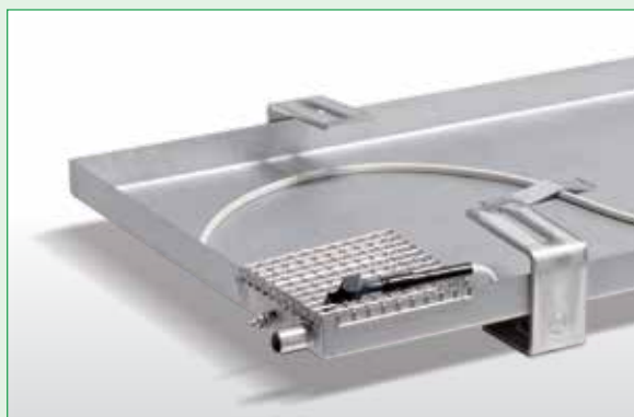
Vana pro zachycení kondenzátu včetně odlučovače oleje z ušlechtilé oceli pro vnější jednotku s teplotně regulovaným topením odtoku kondenzátoru, s mřížkou pro zachycení listů a s odlučovačem oleje
